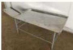
Предназначен для приема колбасных батонов после шприцевания и их дальнейшей вязки и навешивания на колбасные рамы.
